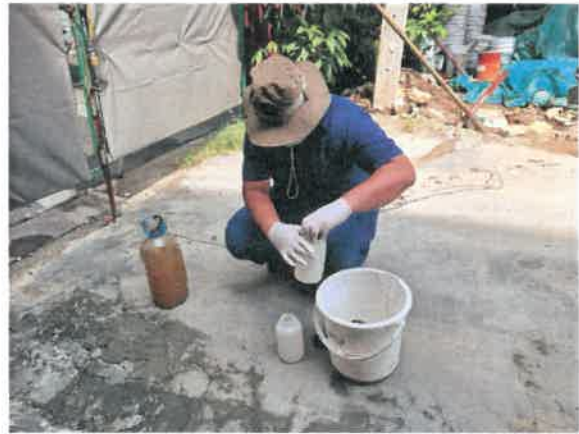
รูปที่ 3.1-2 แสดงจุดเก็บตัวอย่างคุณภาพน้ำทิ้ง บริเวณบ่อพักน้ำสุดท้ายก่อนระบายเข้าสู่ระบบบำบัดน้ำเสียรวมของโรงพยาบาลพระมงกุฎเกล้า
